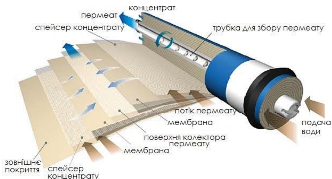
Рисунок 3.3 – Будова та напрями потоків рулонного мембранного елемента зворотного осмосу малої продуктивності
