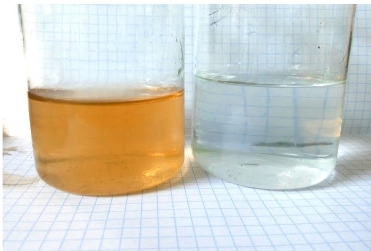
Рисунок 2.3 – Проба вторинно забруднена торфом у порівнянні з дистильованою водою
