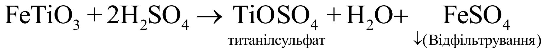
На 1 т  $\text{TiO}_2$  утворюється: 1 т  $\text{FeSO}_4 \cdot \text{H}_2\text{O}$  і 3,5 т  $\text{FeSO}_4 \cdot 7\text{H}_2\text{O}$  та 9 -10 т гідролізної  $\text{H}_2\text{SO}_4$  (15-20%).
