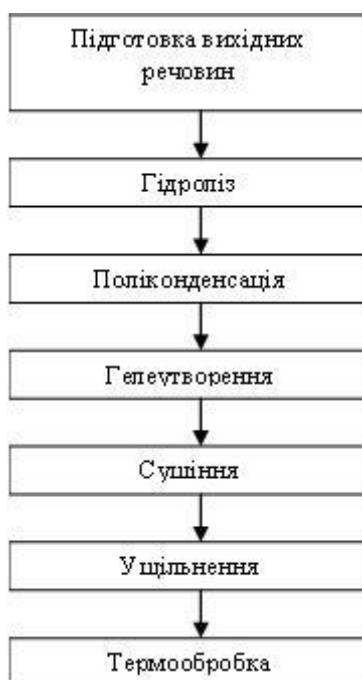
Рис. 2.6. Принципова схема золь-гель методу
